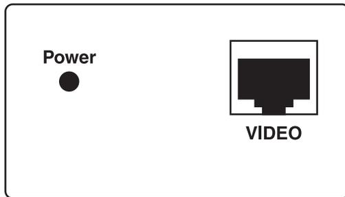
Abbildung 5. Rückseitenansicht der ferngesteuerten Einheit: Stromversorgungs LED, CAT5 Anschluss.
