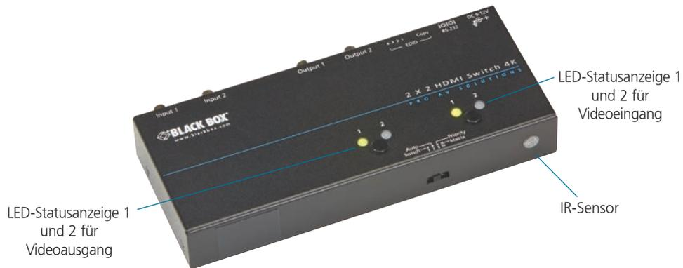
Abbildung 4-1. LED-Anzeige auf der Oberseite des 2 x 2 Switch.
