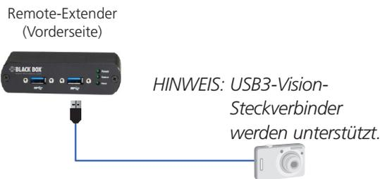
Abbildung QS-5. Verbinden des USB-Geräts mit dem Remote-Extender.
