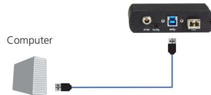
Abbildung QS-8. Verbinden des lokalen Extenders mit dem Computer.
